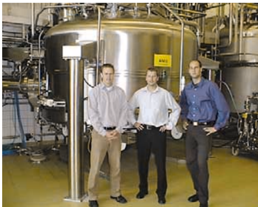
WM-datakonsulterna Ola Petersson och Joban Granman arbetar med validering av AstraZenecas fabrik i Dunkerque i Frankrike. Ansvarig för valideringsprojektet är Fredrik Karlsson, AstraZeneca. Här är det fotograferade framför en filttertork (Nutch) i ACE fabriken. Filttertorken används för att filtrera och torka substansen och anses som en av de mest kritiska utrustningarna i anläggningen.
