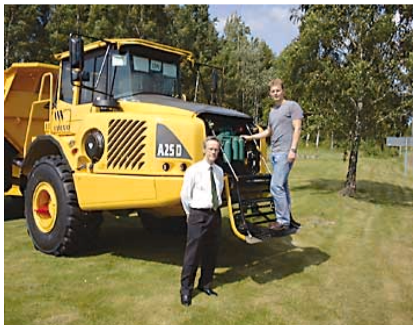
Frontluckan som WM-datakonsulten Roger Melander står på har Volvo fått patent för. Den är konstruerad av Melander. Till vänster Peter Söderberg, utvecklingschef på Volvo Articulated Haulers.
