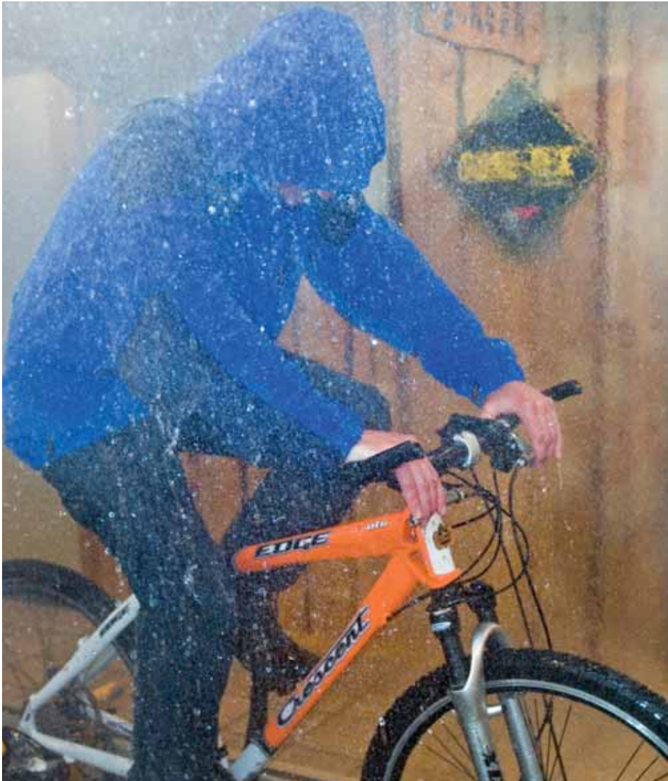
260 liter vatten i minuten sprutar ut i Taigas klimatlabb samtidigt som tre fläktar skapar en pinande kyl-effekt. Här sätts kläderna på hårda prov.
